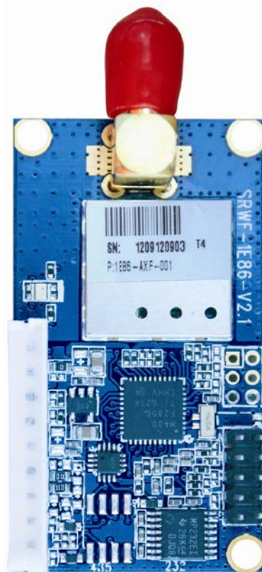
SRWF-1E86物联网自组网 无线模块 433/470/868MHZ 100mW 接口: TTL/232/485
